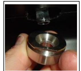
Abnehmbarer Berührschutz aus Edelstahl Bild 2
