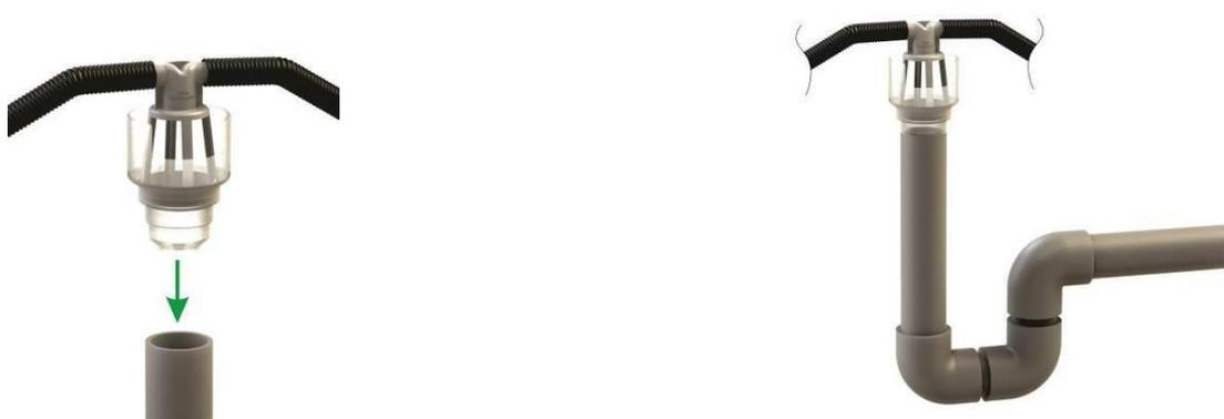
**4.7** Fügen Sie das Gerät in den Salzbehälter ein, in die Seite mit dem runden Ausschnitt. Fügen Sie das Soleventil im Salzbehälter ein. Zum Öffnen der Abdeckung, leicht beide Flanken drücken. Fügen Sie jetzt das Soleventil an der vorgesehenen Stelle ein, in die korrekte Richtung. Achten Sie darauf, dass das Soleventil auf den Boden des Behälters steht. Schließen Sie die Abdeckung wieder.
