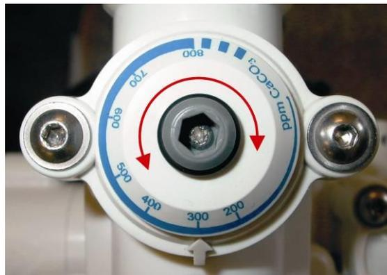
Regulieren Sie dann den Härteregler bis die richtige Einstellung erreicht ist. Dazu wird der Innensechskantschlüssel SW5 benötigt.
