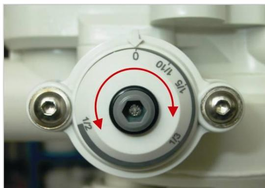
Anmerkung: Stellen Sie den Verschneiderregler an beide Ventilgehäusen immer auf dieselbe Einstellung.
