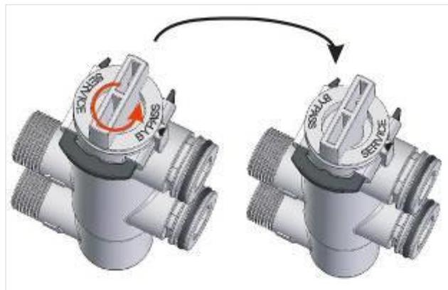
**6.3** Öffnen Sie jetzt einen Hahn hinter dem Enthärter. Möglicherweise entweicht etwas Luft aus dem Hahn. Diese Luft kommt vom Enthärter. Diese Luftentweichung ist einmalig (nur bei Inbetriebnahme). Sobald nur Wasser (und keine Luft) aus dem Hahn strömt, schließen Sie ihn wieder.
