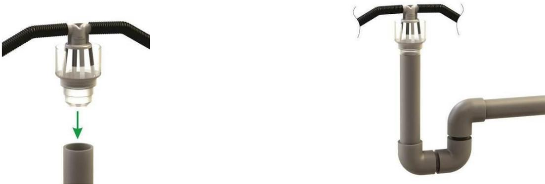
**3.8** Überprüfen Sie, ob das Soleventil richtig montiert ist. Dieses Ventil ist montiert in dem Pökelrohr und muss ganz auf dem Boden des Behälters stehen. Sehen sie nach, ob das Soleventil mit der richtigen Seite nach oben montiert ist. Um dies zu überprüfen, müssen Sie den Deckel von dem Pökelrohr abnehmen.
