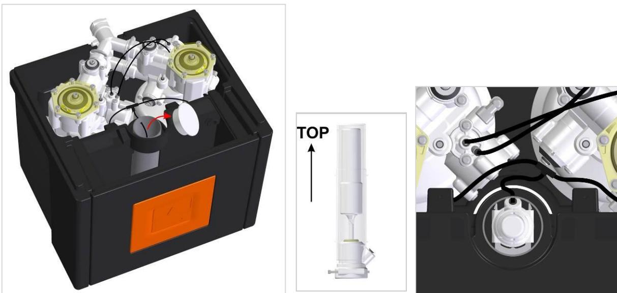
**3.9** Stellen Sie sicher, dass das Soleventil in der richtigen Art und Weise mit dem Gerät verbunden ist. Der Ø4mm schwarze Schlauch kommt von dem Soleventil, durch das Loch von dem Pökelrohr und muss mit dem kleinen T-Stück verbunden sein. Dieses T-Stück verbindet die beiden Schläuche, die aus den beiden Einheiten kommen. Stecken Sie die Schläuche so weit wie möglich (bis Anschlag) in die Schnellkupplungen. Achten Sie darauf, Blockierung bzw. Knickstellen zu vermeiden.
