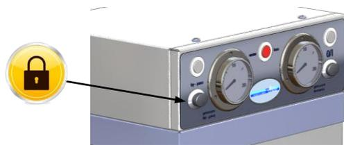
Unterbrechen Sie die Stromversorgung des Magnetventils der Maschine.
