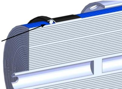
Setzen Sie die Membran vorsichtig in den Sitz ein und achten Sie dabei darauf, dass der O-Ring nicht beschädigt wird.
