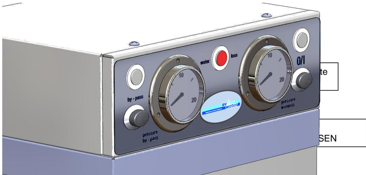
**Drücken Sie die Taste BYPASS nur bei ungenügender Produktion oder Ineffizienz der Osmose-Anlage. Wir empfehlen, einen spezialisierten Anlagentechniker zu beauftragen.**
